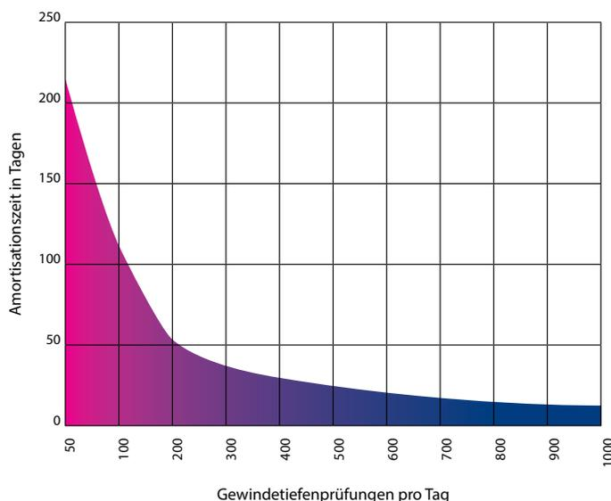
Die dargestellte Amortisation basiert auf Erfahrungswerten bei der Tiefenprüfung von zwei Gewinden M4x6 pro Werkstück. Die Amortisationszeit errechnet sich aus der Ersparnis von ca. 10 Sekunden je Gewinde und einem Stundensatz von 50 Euro.
